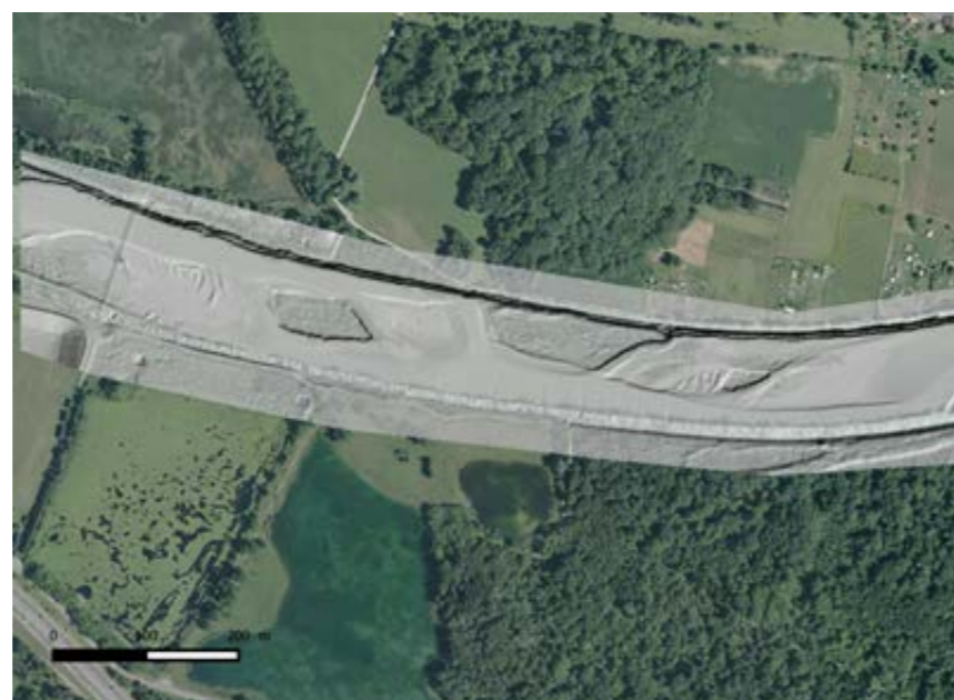
> Illustration d'un levé lidar de cours d'eau : délimitation des chenaux vifs et des bancs de graviers. Amont de la zone de liberté de l'Arve : l'Espace Borne Pont de Bellecombe
