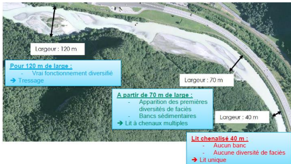
Corrélation entre largeur du lit et diversité d'habitats à la Maladière à Cluses
