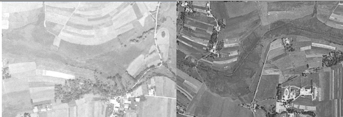
Rectification du lit dans les années 1950 En 1952 (à gauche), des méandres sont visibles. En 1962 (à droite), le lit a été rectifié et est en ligne droite
